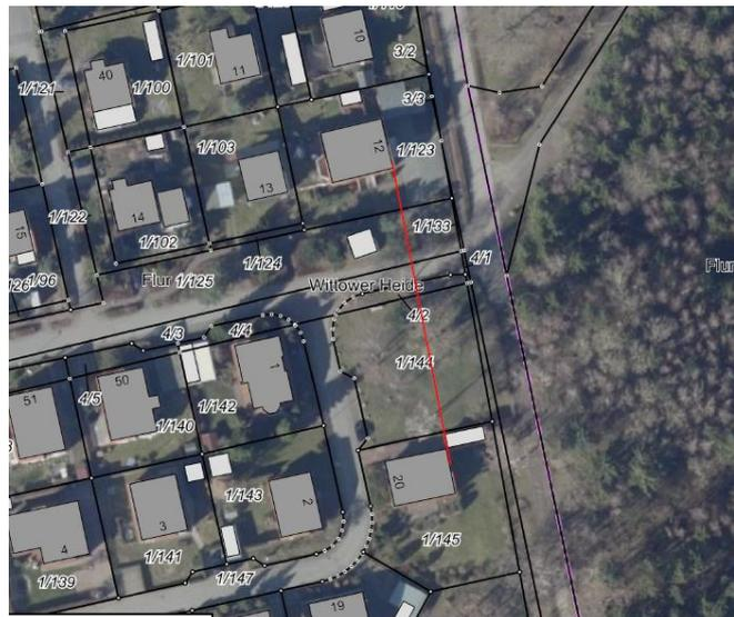
Abbildung 5: Waldfeststellung mit Darstellung der Linie (Rot), von der aus das Plangebiet östlich von Bebauung frei zu halten ist (Quelle Landesforstbehörde M-V)
