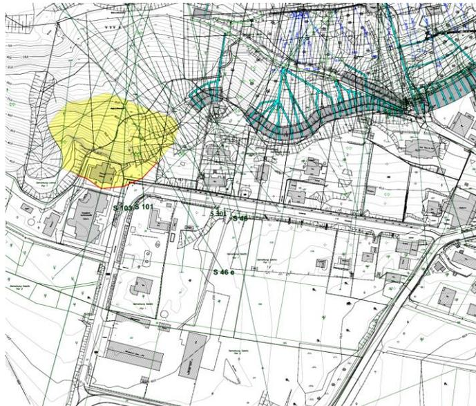
Abbildung 4: Ingenieurgeologisch-geotechnisches Gutachten mit Kennzeichnung des instabilen Bereichs, geo-international Dr. Johannes Feuerbach GmbH 10/2018
