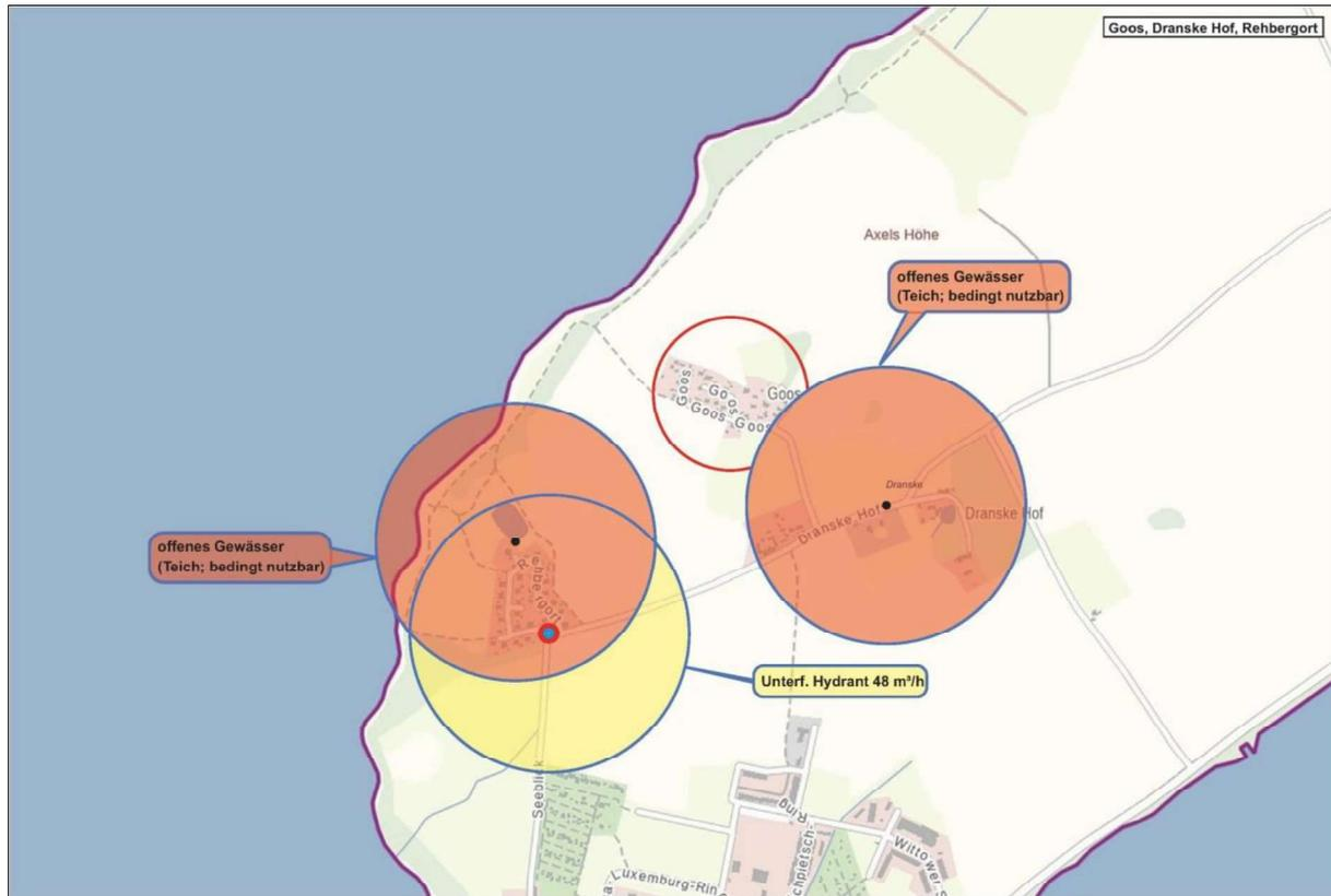
Abbildung 08: Löschwasserversorgung Goos, Dranske Hof, Rehbergort
