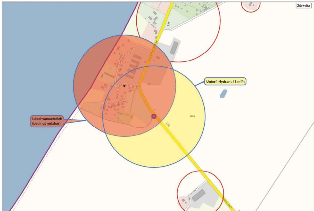
Abbildung 10: Löschwasserversorgung Zürkvitze
